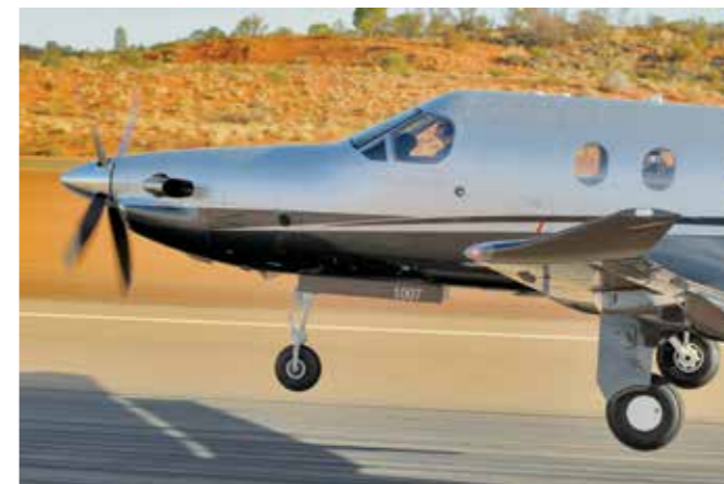
▲ VISTA FRONTAL DEL ATERRIJAJE DEL PC-12. ESTA OPERACIÓN LA PUEDE REALIZAR EN PISTAS DE SOLO 558 METROS DE LARGO.
