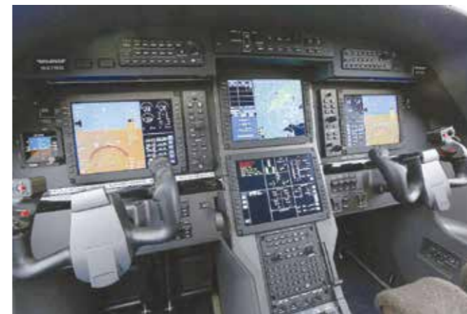
COCKPIT DE ÚLTIMA GENERACIÓN, CONFIGURADO CON DOS PANTALLAS PRIMARIAS DE VUELO Y DOS PANTALLAS MULTIFUNCIONALES.
